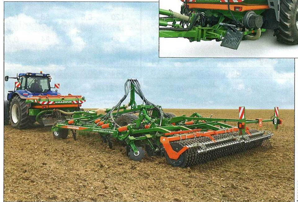
Hier ist der XTender 2200 an einen Grubber Cenius 5003-2TX Super angebaut.
