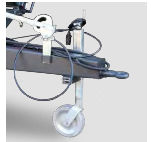
Höhenverstellbares Stützrad. Optional für E15 bis E35, Serie bei E50 und E60.
